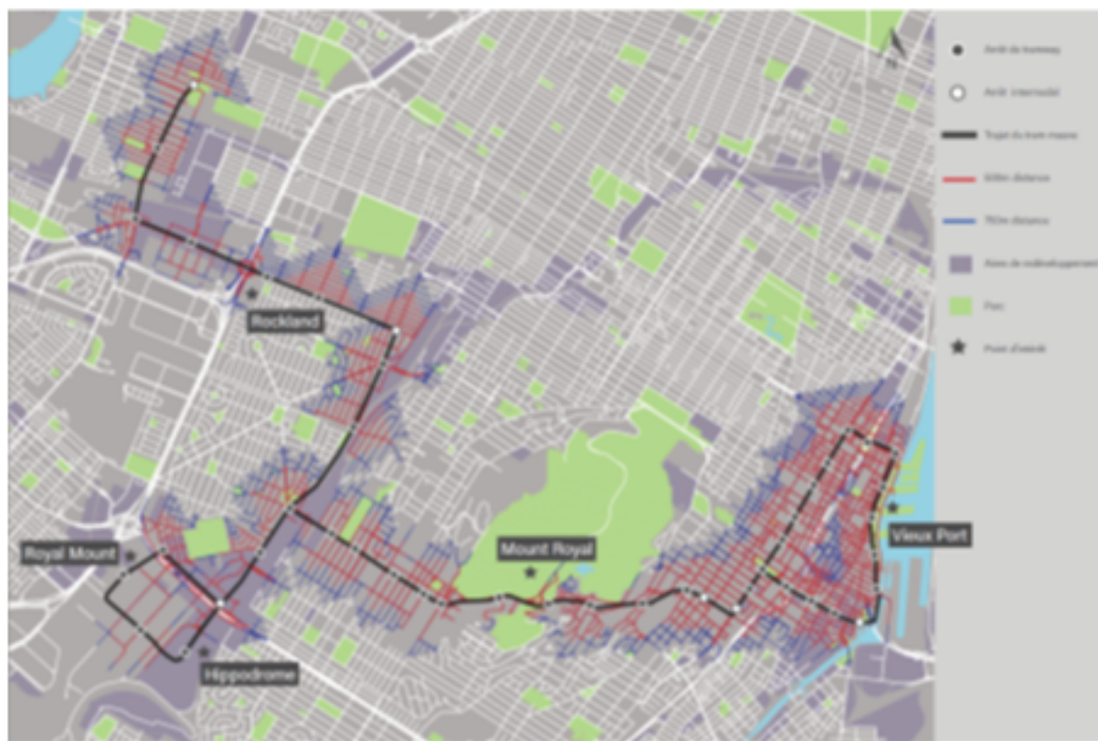
Figure 1 : Carte montrant une proposition de tracé de tramway permettant de desservir l'ÉcoQuartier Namur-Hippodrome ainsi que le secteur Royalmount (distances à 500 mètres de chaque station, en rouge, 750 mètres en bleu).
